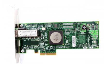
HPE FC2142SR 4GB 1 端口 PCIe X4 光纖通道主機總線適配器，397739-001
