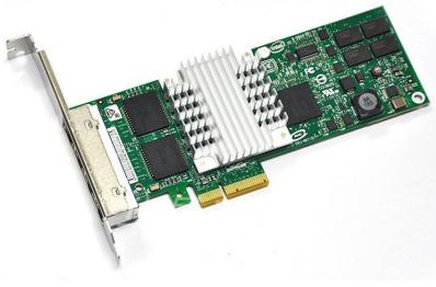
英特爾 PRO/1000 PT 四端口服務器適配器，4 個 RJ45，10/100/1000，PCIe，82571GB
