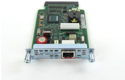
Cisco HWIC-1B-U 1端口ISDN BRI U高速廣域網接口卡
