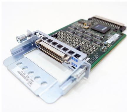
Cisco HWIC-8A/S 8 端口異步/同步串行 HWIC , EIA-232
