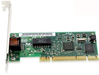
英特爾 PRO/100 M 台式機適配器，RJ45，10/100，PCI，82551
