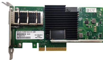
英特爾以太網單端口 40GbE QSFP+ 聚合網絡適配器
