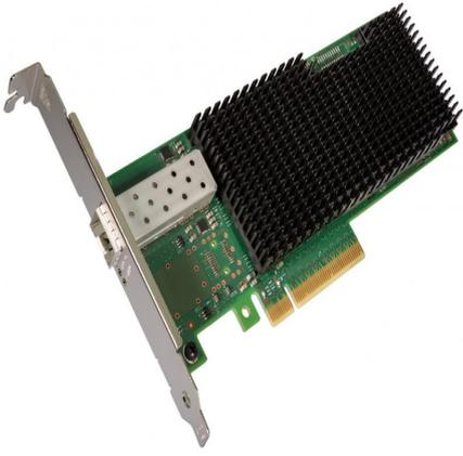
英特爾 XXV710 25GbE 單 SFP28 端口以太網網絡適配器
